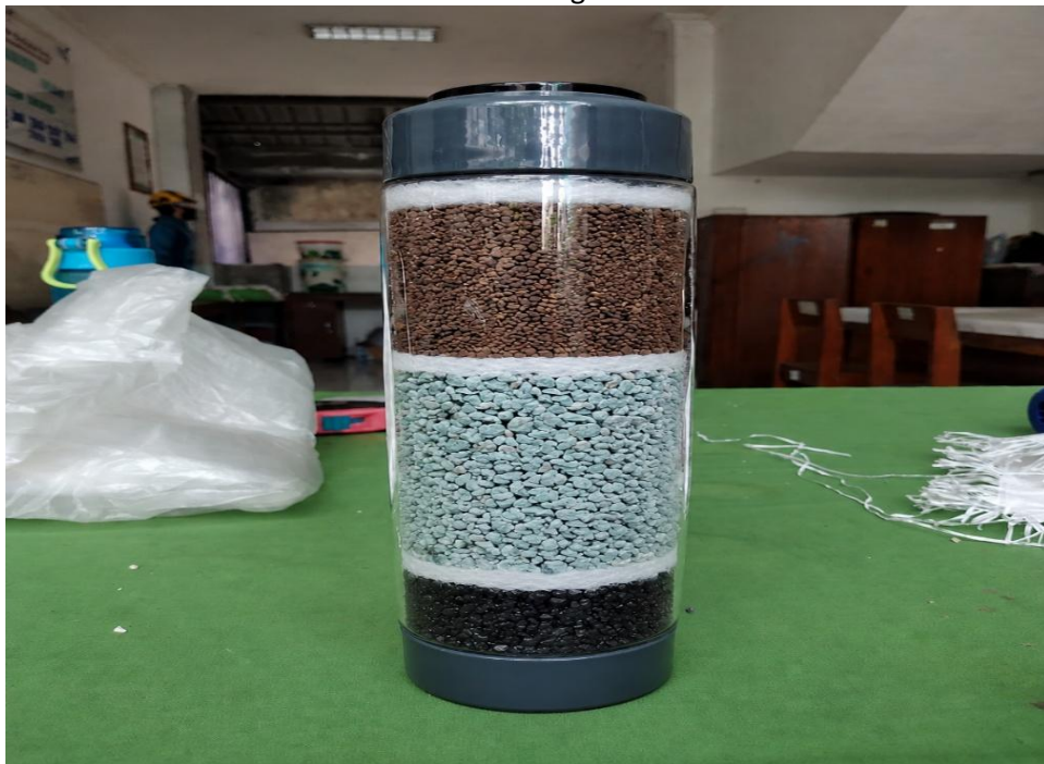
Catridge dengan Media Pasir Mangan, Zeolit, dan Arang Aktif
