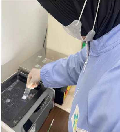
Proses merekatkan pita jaringan ke object glass
