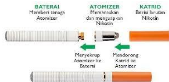
Gambar 3. Struktur dasar rokok elektrik Sumber: BPOM, 2017
