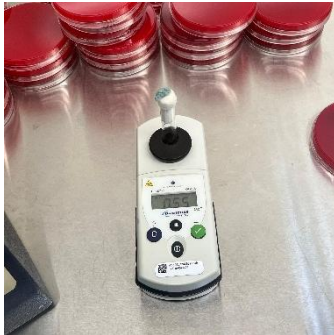
Pengecekan suspensi dengan turbidimeter
