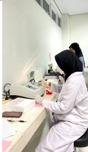
Proses pemeriksaan menggunakan spektrofotometer
