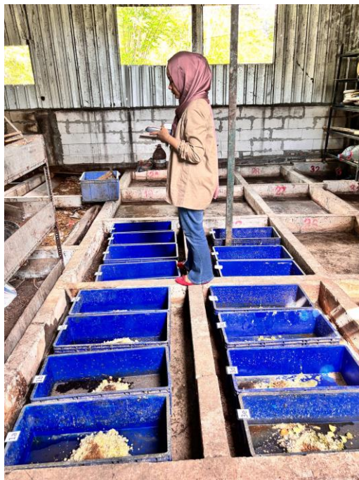
Gambar 19. Peneliti melakukan pengukuran kondisi fisik (suhu, kelembaban, intensitas cahaya) ruangan budidaya Maggot BSF setiap hari selama periode 10 hari
