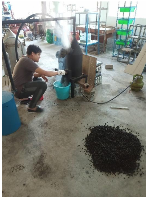
Proses karbonasi cangkang kelapa sawit
