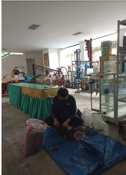
Proses penumbukan arang cangkang kelapa sawit
