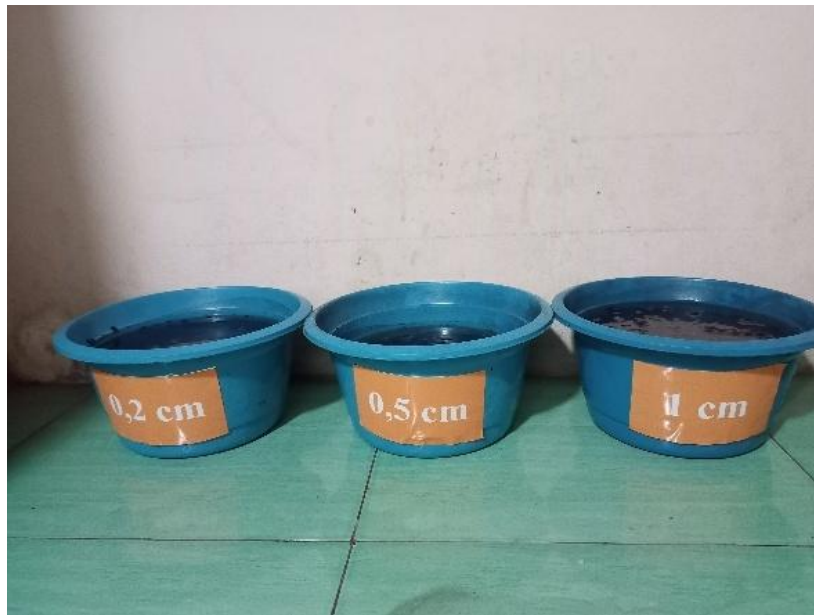
Proses aktivasi arang cangkang kelapa sawit menggunakan H_3PO_4 selama 16 jam
