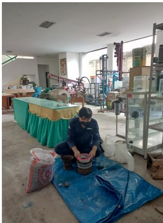
Proses pengayakan arang cangkang kelapa sawit
