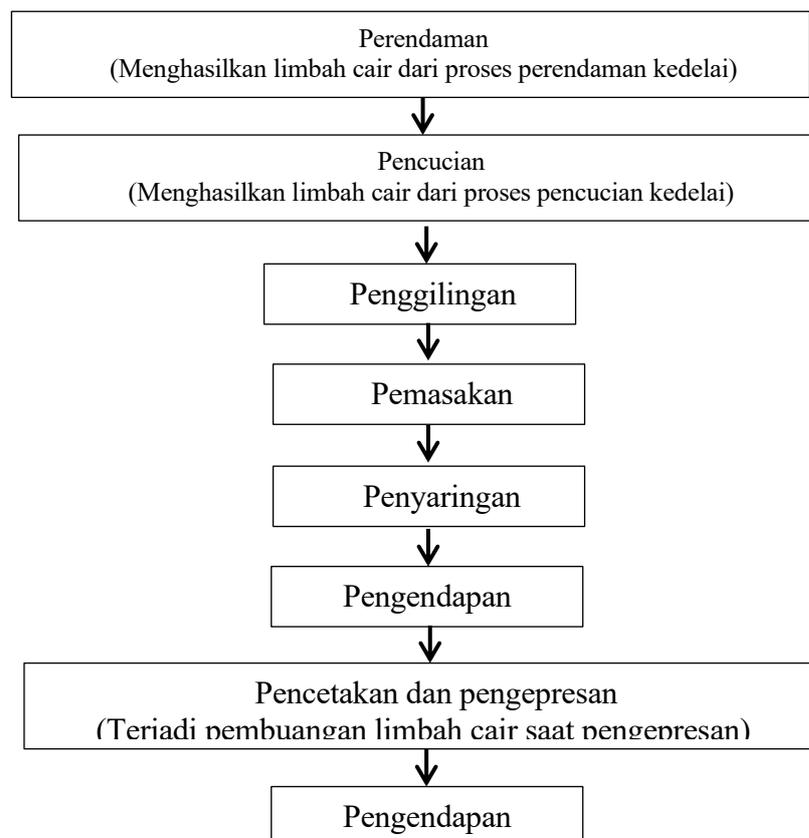
Gambar 1. Alur Proses Produksi Tahu
