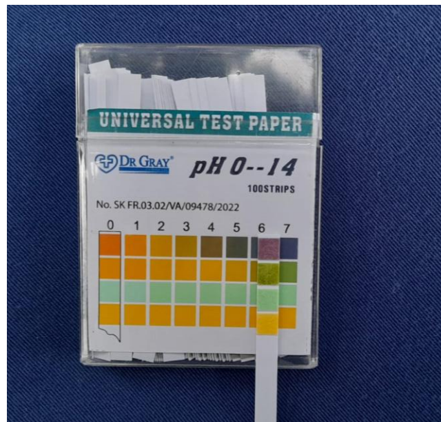
Gambar 25. Hasil Pembacaan pH Limbah Cair Outlet Industri Serabi Solo Pratama menggunakan lakmus
