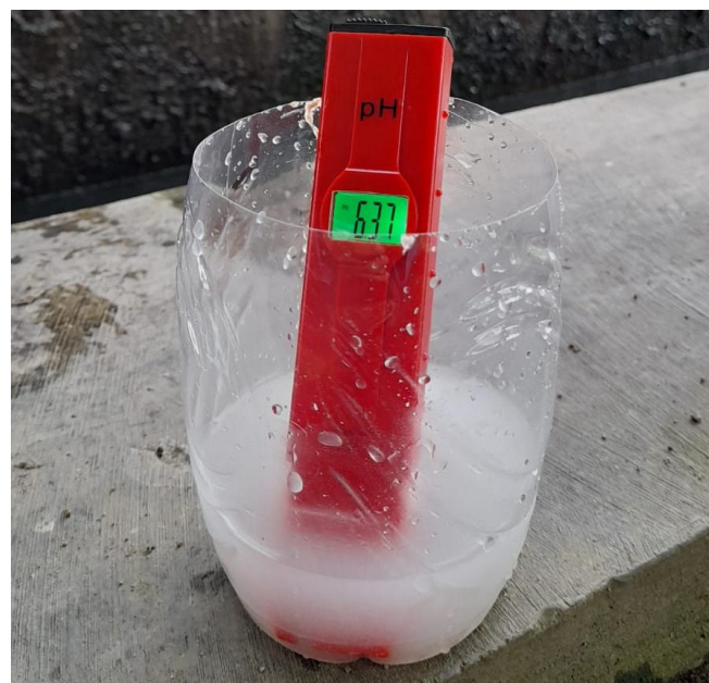
Gambar 26. Hasil Pembacaan pH Limbah Cair Outlet Industri Serabi Solo Pratama menggunakan pH meter
