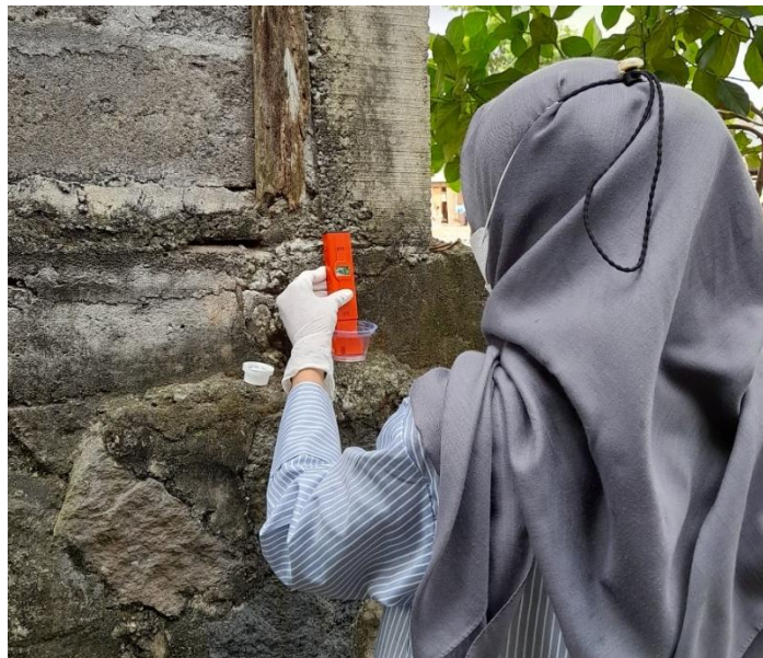
Gambar 24. Pengujian pH Limbah Cair Outlet Industri Serabi Solo Pratama menggunakan pH meter
