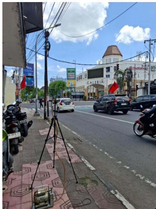
Gambar 8. Pengambilan Sampel Kadar Debu Kawasan Non RTH di Jalan Urip Sumoharjo
