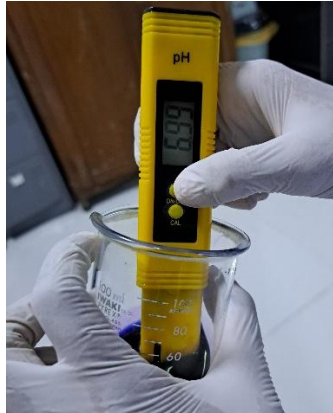
Uji pH larutan Giemsa 6.8 menggunakan pH meter
