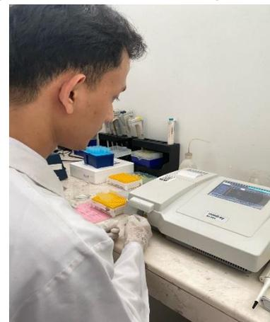
Proses pembacaan pada spektrofotometer
