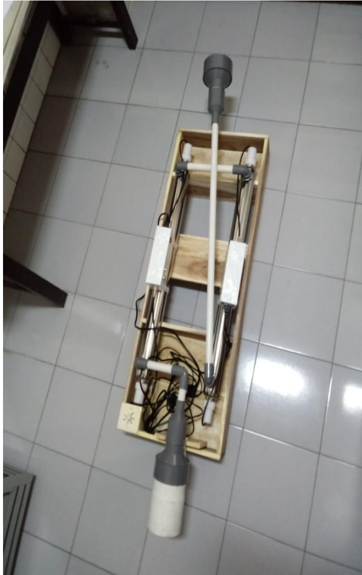
Gambar 3. Rangkaian alat setelah udara dialirkan ke dalam 2 tabung UV.
