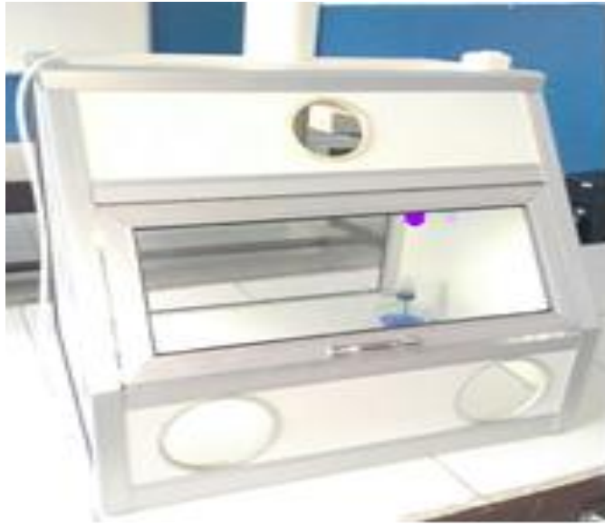
Gambar 9. Kreasi alumunium sebagai alternatif pengganti kabinet biosafety kelas I.
