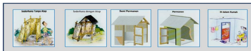
Gambar 2.2 bangunan atas jamban sumber Permenkes No.3 Tahun 2014
