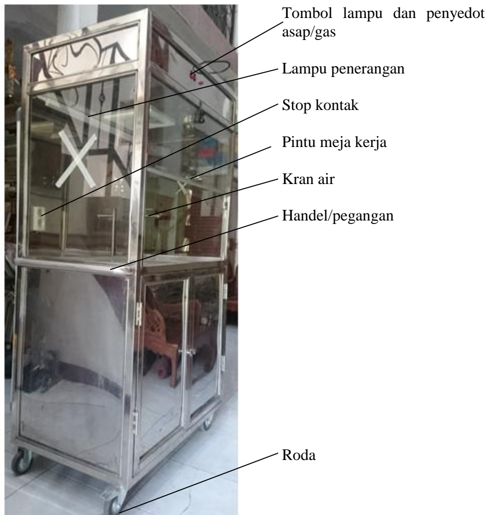
Gambar 4.1 Tampak depan-kanan fume hood portable yang telah dibuat dalam penelitian ini
