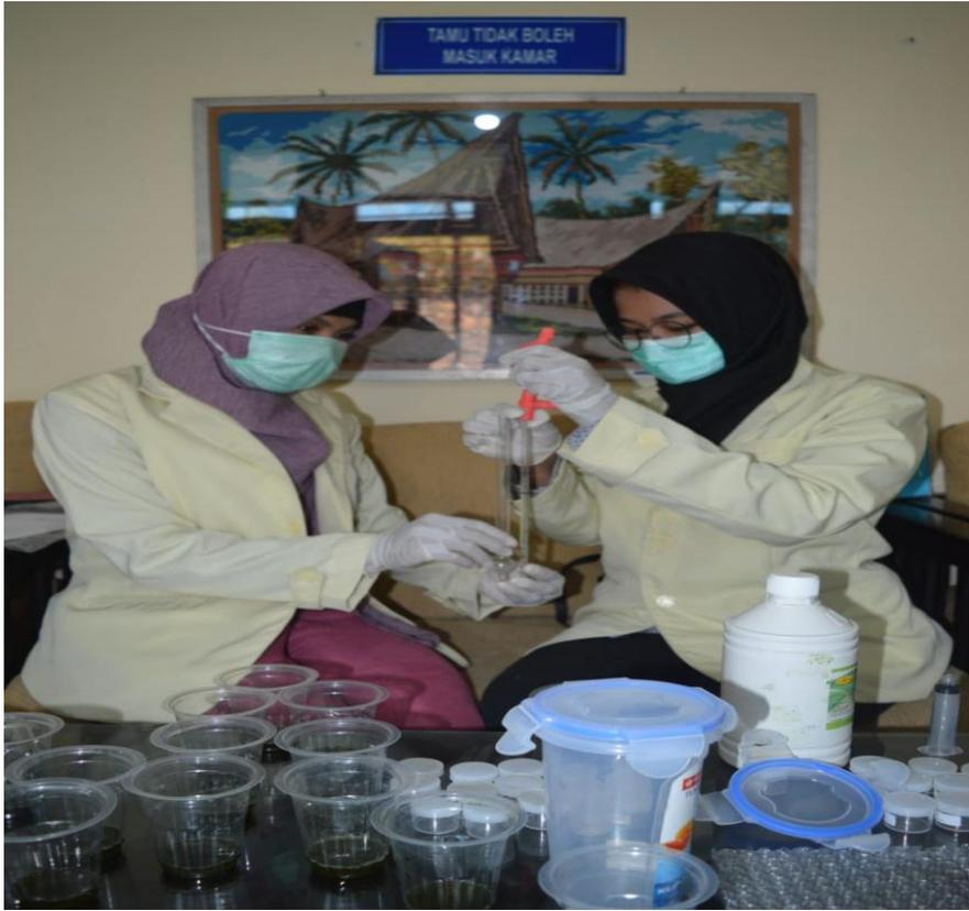
proses perhitungan viskositas menggunakan alat viskometer *Ostwald*
