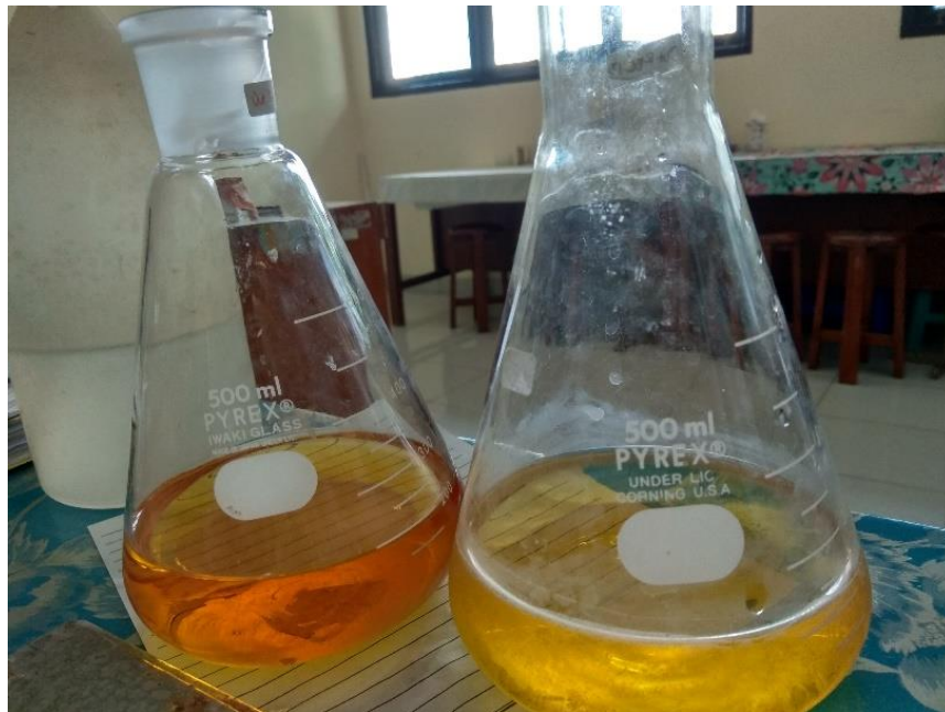
Gambar 16. Air limbah diukur menggunakan gelas ukur kemudian dimasukkan kedalam erlenmeyer 500 ml, selanjutnya titrasi dengan larutan Natrium Thiosulfat sampai berwarna kuning muda seperti erlenmeyer bagian kanan
