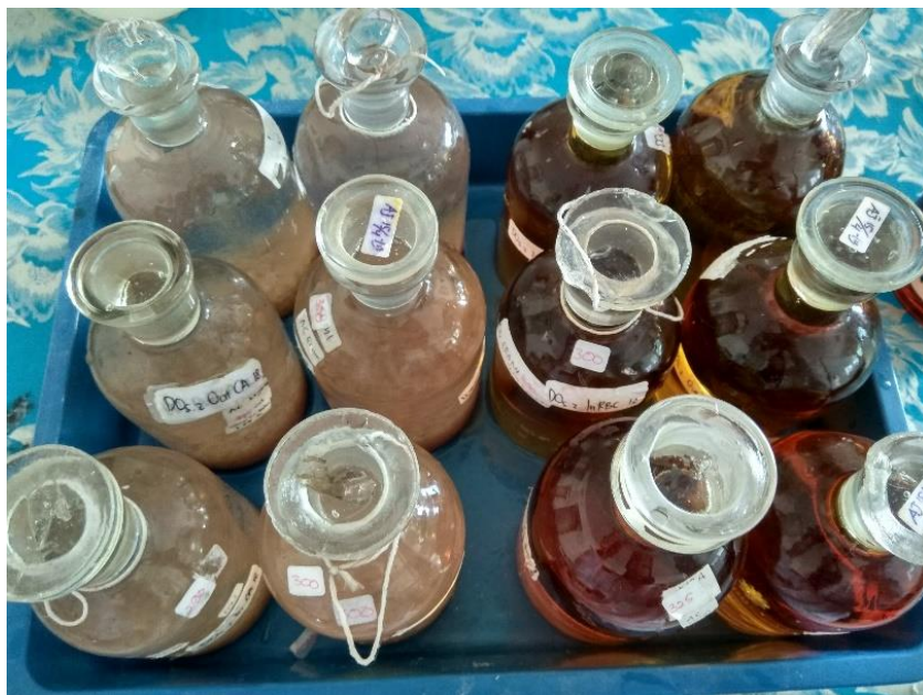
Gambar 15. Setelah diberi \text{MnSO}_4 , pereaksi \text{O}_2 maka akan terlihat seperti botol bagian kiri, setelah diberi \text{H}_2\text{SO}_4 air limbah akan terlihat seperti bagian kanan
