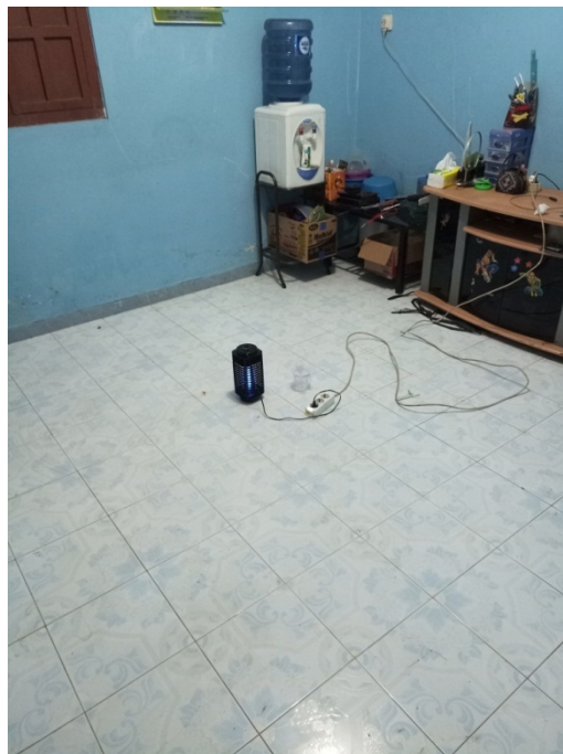
Gambar 8. Pemasangan Perangkat nyamuk Ultraviolet berdaya 5 watt.
