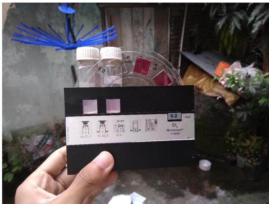
Gambar 6. Pengukuran sisa klor setelah pemasangan klorin difuser selama 3 hari
