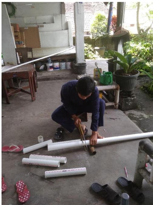
Gambar1. Proses pembuatan klorin difuser
