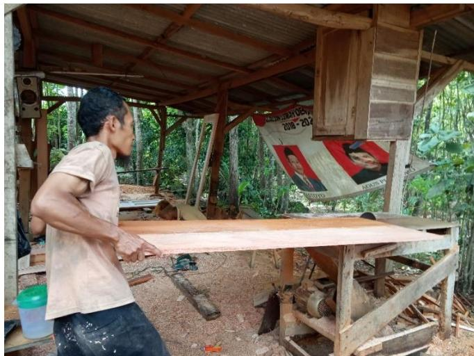
Proses pemotongan menggunakan mesin *circle*
